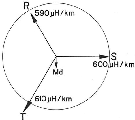
Fig. 3. Gegeninduktivität zwischen den drei Phasen einer symmetrisch belasteten Drehstromleitung und einer Leitung mit Erdrückleitung im Abstand  $x$  vom mittleren Phasenseil
