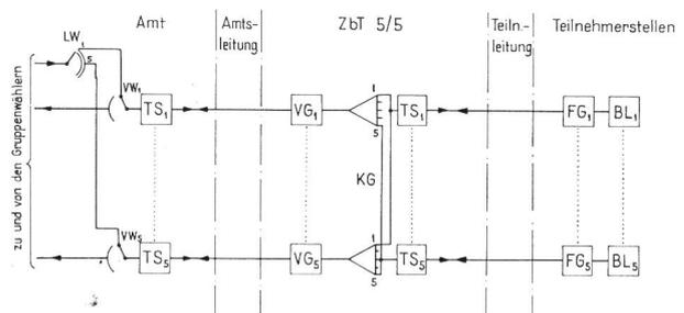
Fig. 2. Blockschemata der Fernschreibzentrale 5/5
