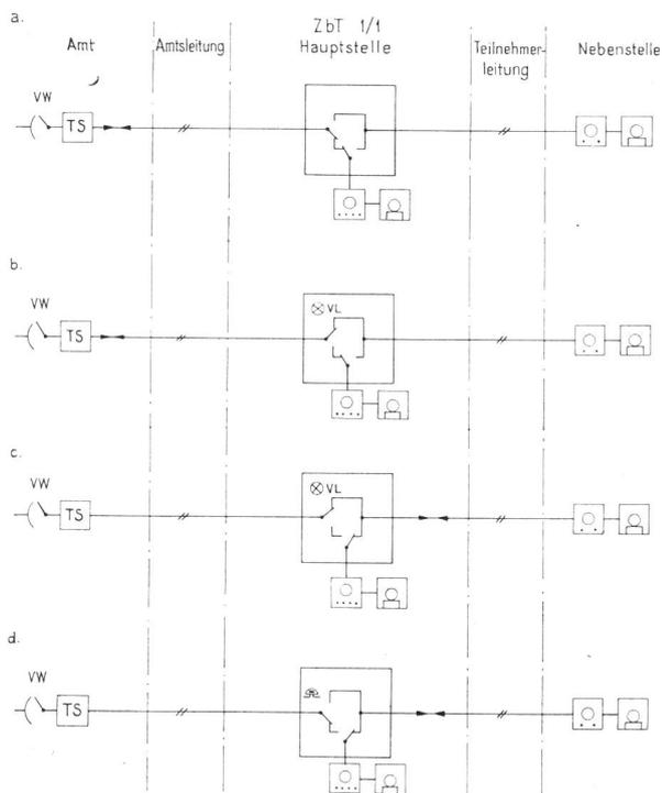
Fig. 4. Fernschreibzentrale 1/1 «Betriebsmöglichkeiten»
