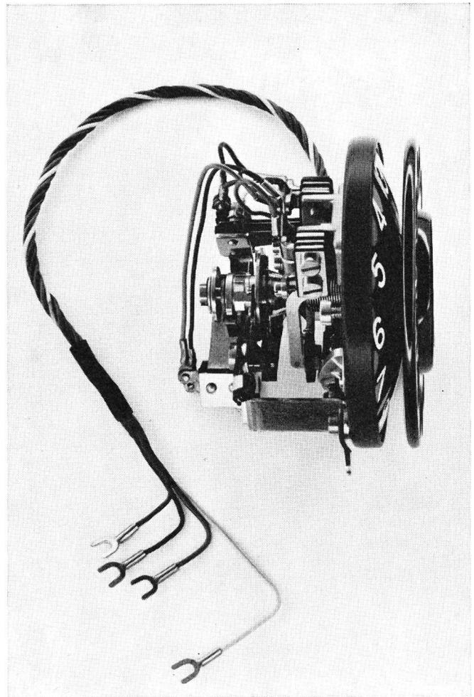
Fig. 5. Nummernschalter mit Dekadensperre
