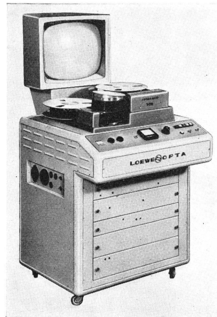
Fig. 7. Prototyp des magnetischen Bildaufzeichnungsgerätes «Optacord 500» von Loewe-Opta
