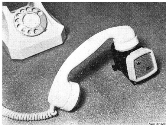
Fig. 2. Amplificateur à liaison électromagnétique non admis par les PTT
