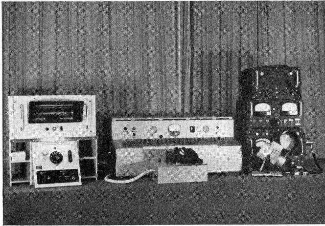
Fig. 5. Serie-Prüfgeräte für Teilnehmerstationen Links: Nummernschalter-Prüfgerät Mitte: Stationsprüfgerät Rechts: Mikrophon- und Hörkapsel-Prüfgerät Instruments d'essais de série pour appareils d'abonnés à gauche: instrument d'essai de cadrans d'appel au milieu: instrument d'essai d'un poste d'abonné à droite: instrument d'essai de capsules microphoniques et d'écoute Strumenti di prova in serie per apparecchi d'abbonati a sinistra: apparecchio di prova dei dischi di chiamata in mezzo: apparecchio di prova delle stazioni telefoniche a destra: apparecchio di prova delle capsule microfoniche e dei ricevitori
