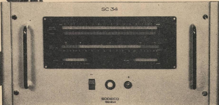
Automatische Messung der Gesamtablaufszeit von 10 Impulsen • Messung der Dauer jedes einzelnen Impulses und automatische Berechnung der zulässigen Toleranzgrenzen • Kontrolle der Hilfskontakte • Leicht ablesbare Anzeige durch Leuchtfelder • Hochpräzise Zeitmessung mit Quarzoszillator.
