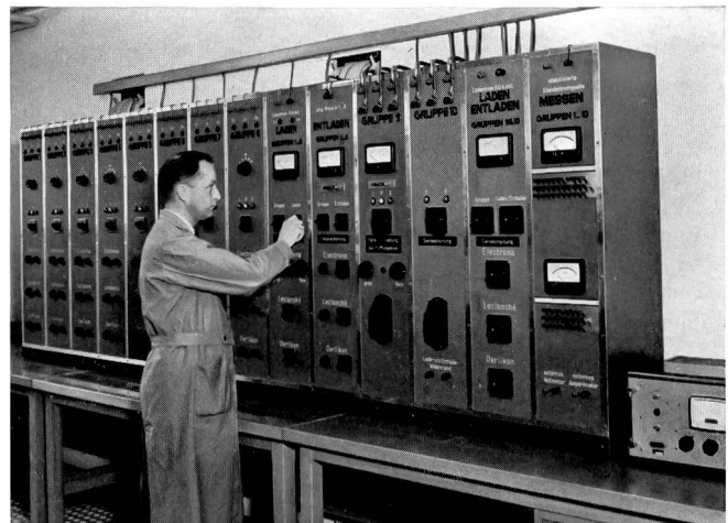
Fig. 1 Versuchsanlage für den Betrieb von Akkumulatoren bei konstanten Zellenspannungen
