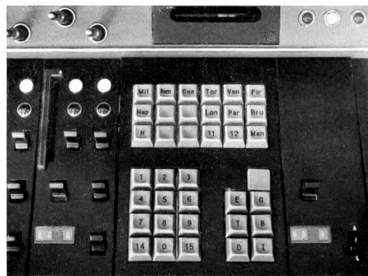
Fig. 5 Détail du pupitre. Le clavier de direction et le clavier de numérotation avec la lampe BLR d'invitation à transmettre
