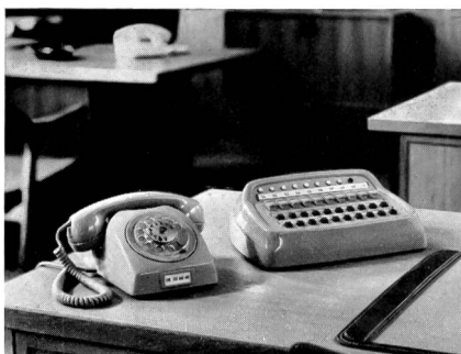
Fig. 7 Leitungswähler für 20 Nebenstellenanschlüsse und 8 Amtsleitungen (Intercom-System)
