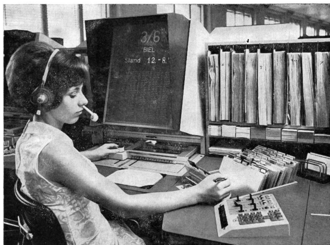
Fig. 6 Mikrofilm-Leseplatz mit Lesegerät, Mikrofilmkartei und Telefon-Bedienungsaggregaten. Anhand des projizierten Leitbildes kann die Filmbühne auf die richtige Koordinate eingestellt werden
