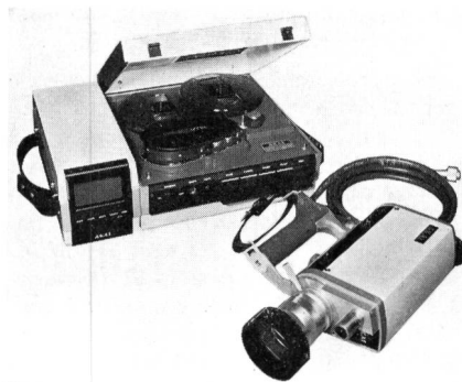
Fig. 2 \frac{1}{4} -Zoll-Video recorder mit Monitor und Kompaktkamera aus Japan
