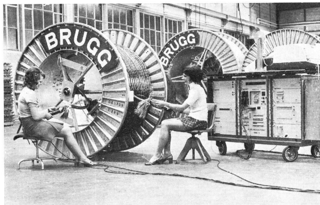
Fig. 4 Kabelmessautomat KMA 3B beim Prüfen einer Fabrikationslänge Dispositif automatique de mesure des câbles KMA 3B en place pour l'essai d'une longueur de fabrication
