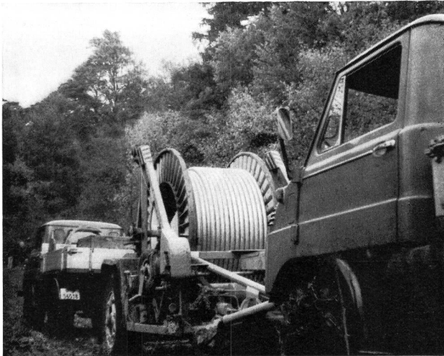
Fig. 3 Transport de câble en terrain accidenté
