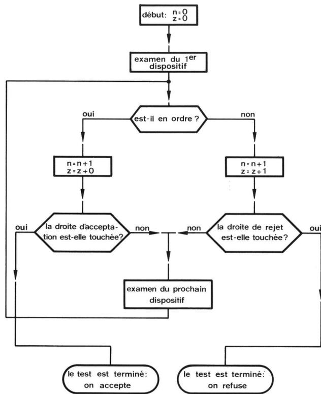
Fig. 7 Diagramme fonctionnel expliquant le déroulement du test
