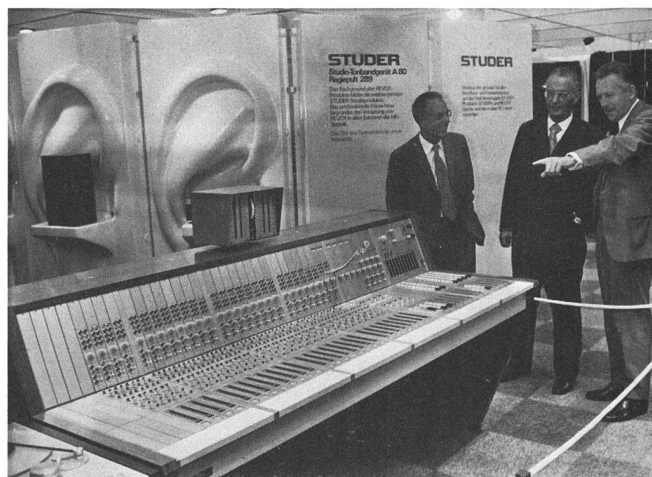
Fig. 4 Tonregiepult für ein Radiostudio der SRG, hergestellt von einem Schweizer Unternehmen. Das ganze Pult ist auf leicht auswechselbaren Steckeinheiten aufgebaut
