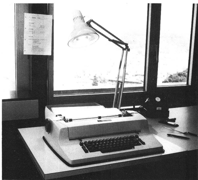
Fig. 1 Die Datenstation (Terminal) IBM 2741. Schreibgeschwindigkeit etwa 15 Zeichen/s
