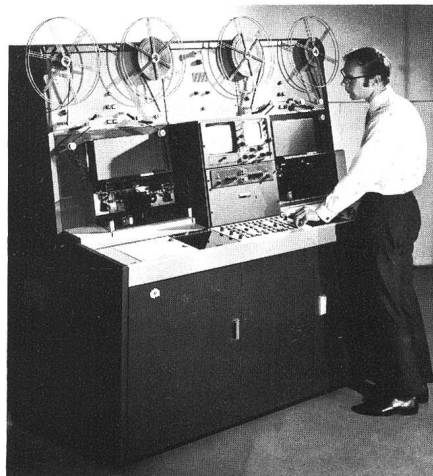
Fig. 4 Film- und Diaabtaster von Marconi für Normal-, Langsam- und Stillstandsprojektion – Télécinéma et analyseur diapositives de Marconi, pour projection normale, lente et fixe
