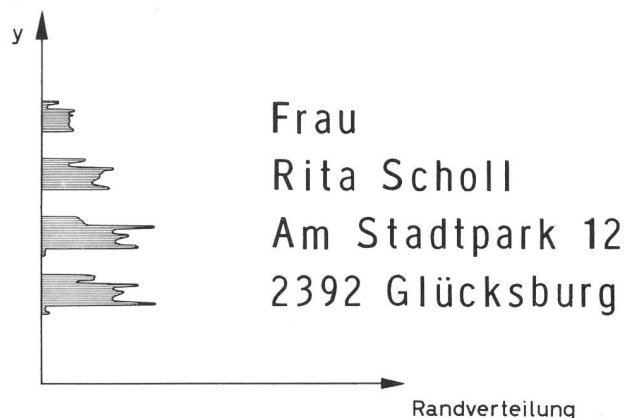
Fig. 4 Suchen der relevanten Anschriftzeile durch Horizontalprojektion und Maximumsuche in der Randverteilung - Recherche de la ligne déterminante de l'adresse par projection horizontale et détection du maximum dans la distribution marginale de l'information
