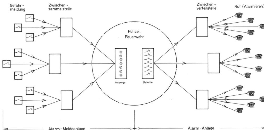
Fig. 1 Alarmmeldeanlage und Alarmanlagebezeichnungen sowie Aufgabenbereiche
