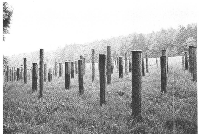
Fig. 6 Stangengarten für Dauerversuche bei Luzern
