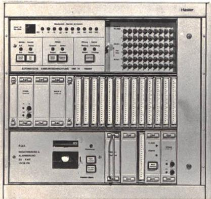
Ein einziges Gerät des Systems Hasler KME 74 ermöglicht die zyklische Kontrolle des Isolationswiderstandes von 60 Kabeln Ihres Telefon-, Telex- und Datennetzes
