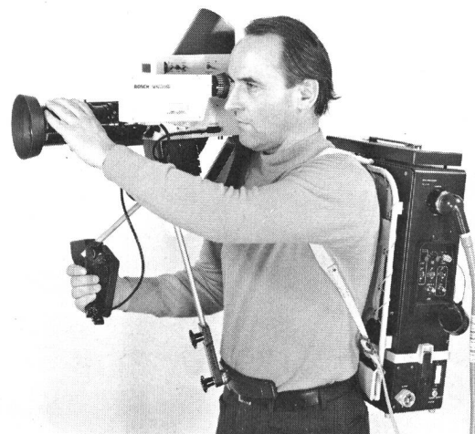
Fig. 2 Caméra portable autonome. La tête de caméra avec son optique se trouve sur l'épaule de l'opérateur; le caisson dorsal contient, dans sa partie supérieure, toute l'électronique nécessaire pour produire un signal vidéo complet. Les batteries sont logées dans la partie inférieure
