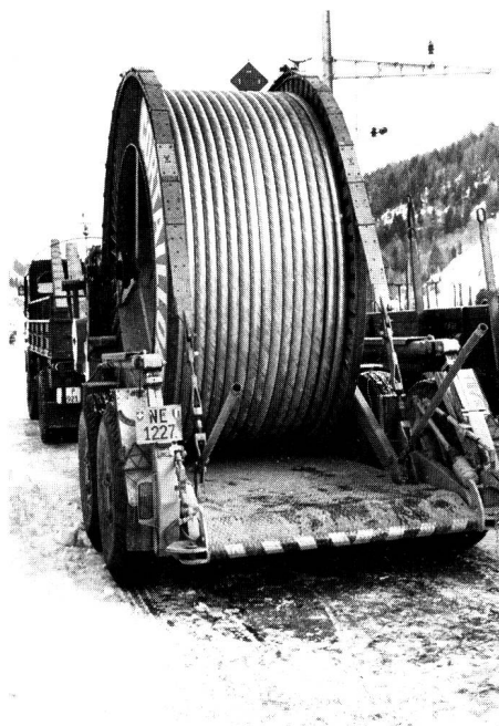
Fig. 2 Der mit einem vollen Kabelhaspel beladene 20-t-Tiefganganhänger. Gut sichtbar sind die zwei auf den Haspelflanschen liegenden Bremsbänder — Il rimorchio a pianale ribassato da 20 t con un aspo pieno. Ben visibili i due freni a nastro applicati alle flange dell'aspo
