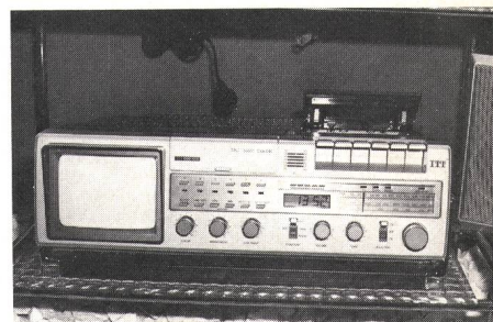
Fig. 8 Mini-Fernsehgerät, Kassettenrecorder, Radio und Wecker in einem Gerät
