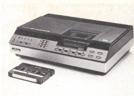
Fig. 4 Videorecorder des Systems 2000 mit Wendekassette, ausgestattet mit Mikroprozessorsteuerung, Vorprogrammierung von 5 Sendungen innerhalb 16 Tagen, 7fach schnellem Bildvorlauf und 5fach schnellem Bildrücklauf, Stehbild und 2 x 4 Stunden Spielzeit (Werkfoto: Metz)
