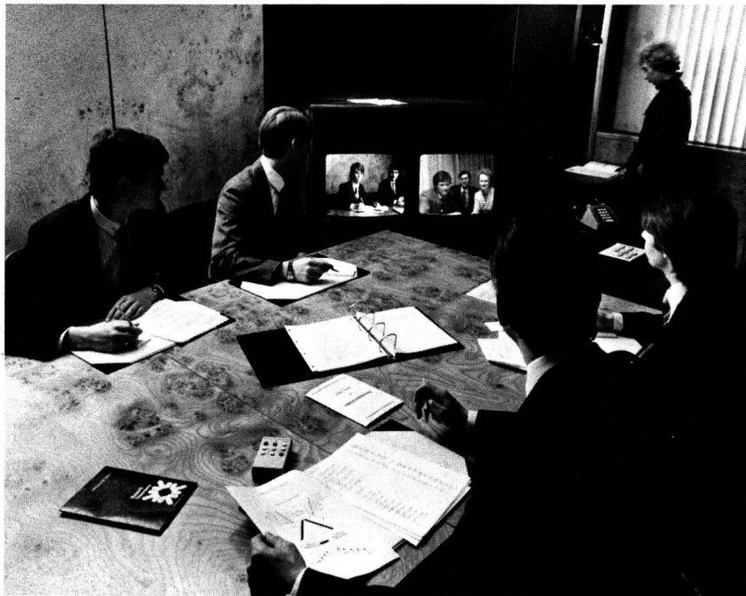
Fig. 1 Die Videokonferenzsrausrüstung besteht aus zwei Monitoren (im Hintergrund) und zwei Kameras, von denen die eine zur Übertragung von Dokumenten (rechts neben den Monitoren) eingesetzt werden kann. (Bild BN)
