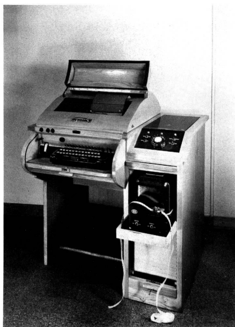
Télécopieur Siemens T 37 et transmetteur de bande perforée Lorenz
