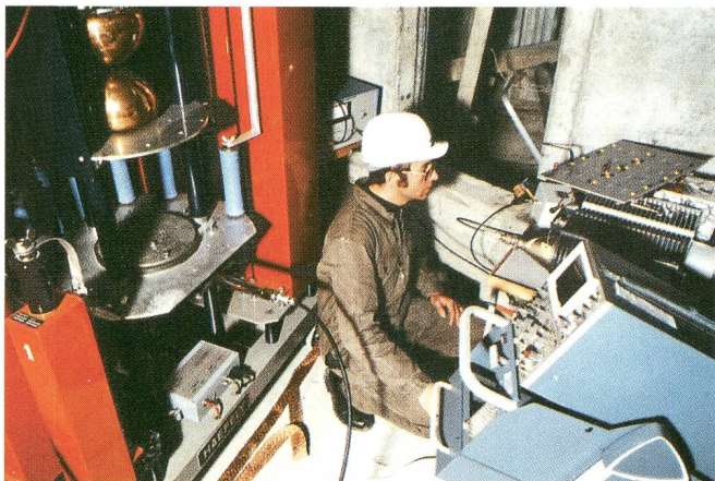
Messungen mit simuliertem Blitzstrom – Mesures avec un courant de foudre simulé
