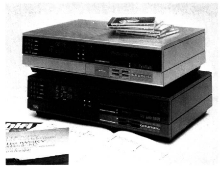
Fig. 6 In ihrem Äusseren gleichen sich die von Philips und Grundig entwickelten Video-2000- und VHS-Recorder. Die VHS-Geräte sind in technischen Einzelheiten gegenüber der fernöstlichen Konkurrenz verfeinert worden. Oben die 2000er, unten die VHS-Ausführung der HiFi-Version
