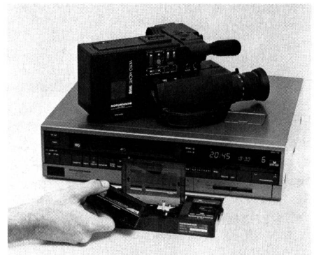
Fig. 7 Kamerarecorder mit der kleinen VHS-C-Kassette, die, in einen Adapter eingesetzt, auf jedem normalen VHS-Recorder abgespielt werden kann.
