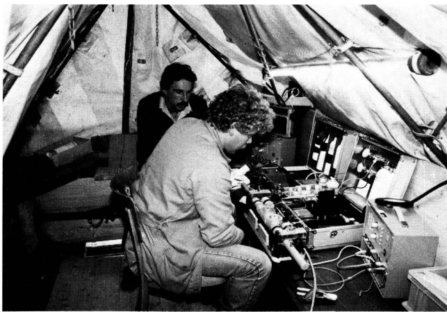
Fig. 10 Spleissarbeiten im Felde – Travaux d'épissure en campagne
