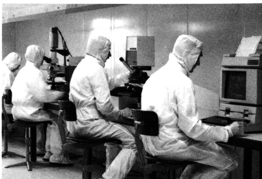
Fig. 5 Im Mitec-Werk in Oudenaarde bei Gent werden die Wafers – auf denen sich über 100 VLSI befinden – mit modernsten Anlagen weitgehend automatisch getestet
