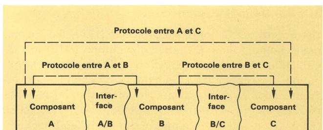
Un protocole permet de régler les interactions entre 2 composants distants l'un de l'autre, par exemple A et C
