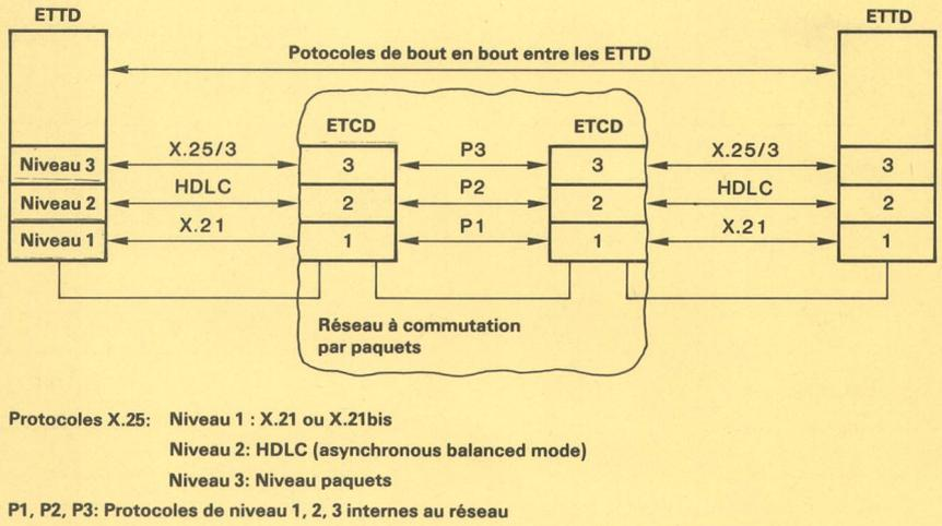
Fig. 12 Exemple de structure mixte en cascade et hiérarchique: communication entre deux ETTD à travers un réseau X.25
