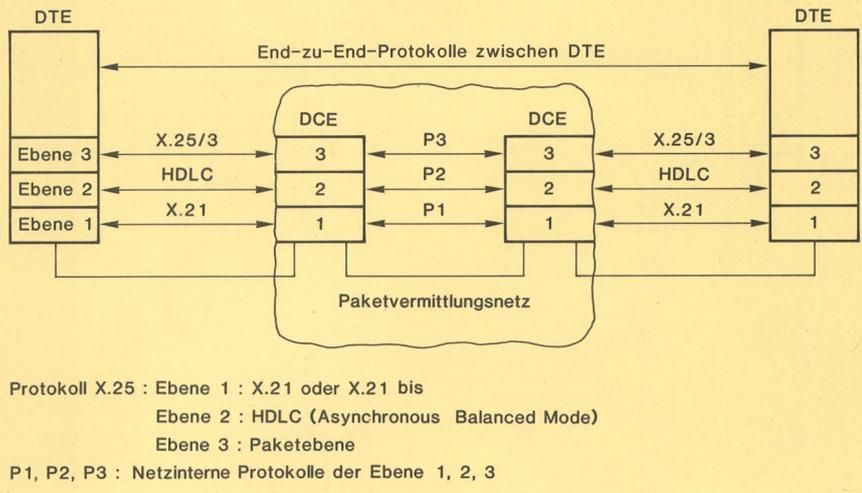
Fig. 12 Beispiel einer gemischten Struktur (hierarchisch und in Kette): Kommunikation zwischen zwei Datenkommunikationseinrichtungen (DTE) über ein X.25-Netz
