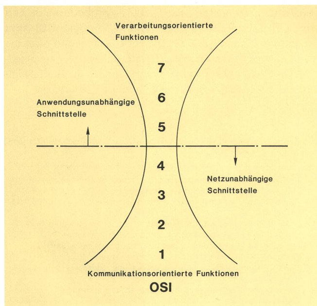
Fig. 11 Die Transportschicht als einheitliche Trennstelle zwischen kommunika- tions- und applikationsorientierten Funktionen
