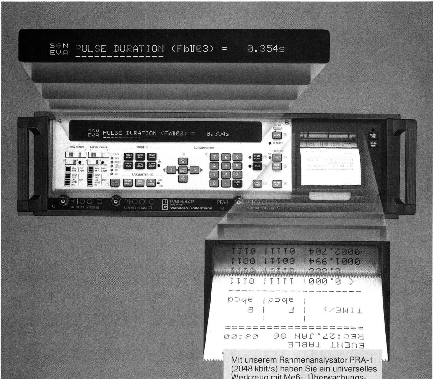
Mit unserem Rahmenanalysator PRA-1 (2048 kbit/s) haben Sie ein universelles Werkzeug mit Meß-, Überwachungs- und Signalerzeugungs-Möglichkeiten für Zeitmultiplex-Systeme komplett und kompakt zur Hand. Zwei Empfangsteile für Rahmenüberwachung und Analyse der Kennzeichenkanäle in beiden Richtungen. Analogmessungen im Fernsprechkanal. Sendeteil für Schleifenmessungen. Prüfung von Fehlererkennungsschaltungen; CRC-4-Test. Ausbaubar zum universellen Bitfehler-Meßplatz, usw., usw.
