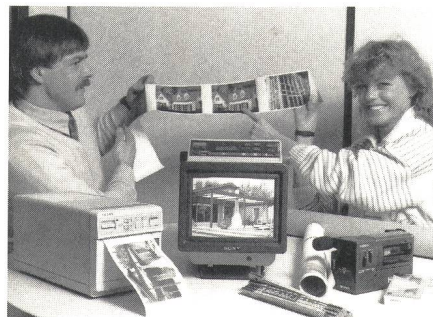
Fig. 17 «Eingefrorene» Fernsehbilder lassen sich mit diesem Videoprinter schwarz auf weiss festhalten
