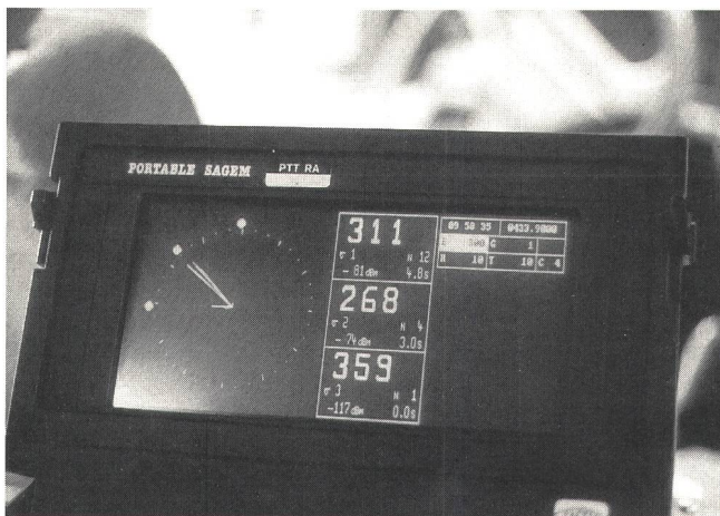
Fig. 4 Bildschirm des Peilers TRC 296 D
