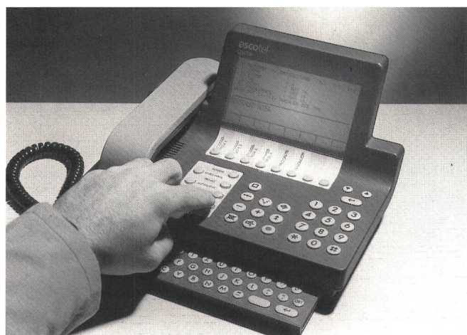
Fig. 9 L'Ascotel Crystal è un terminale adatto all'ISDN. Ad ogni impianto possono essere allacciati uno o due apparecchi di commutazione attraverso il bus S a quattro conduttori. L'apparecchio svolge la funzione di commutatore e serve da apparecchio per la programmazione. Sono previste altre possibilità d'impiego
