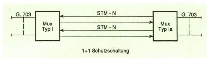
Fig. 11 Verbindung von zwei STM-N-Terminals mit G.703-Schnittstellen
