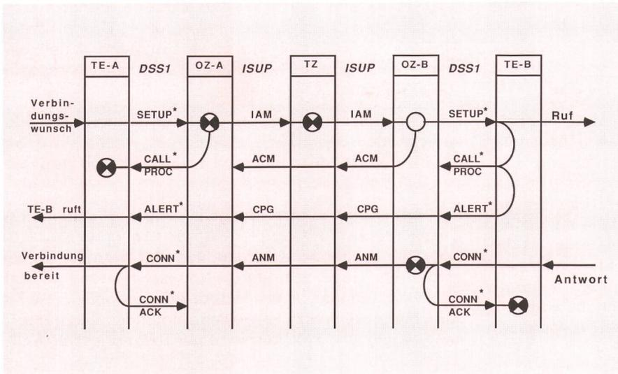
Fig. 2 Aufbau einer Swissnet-Verbindung
