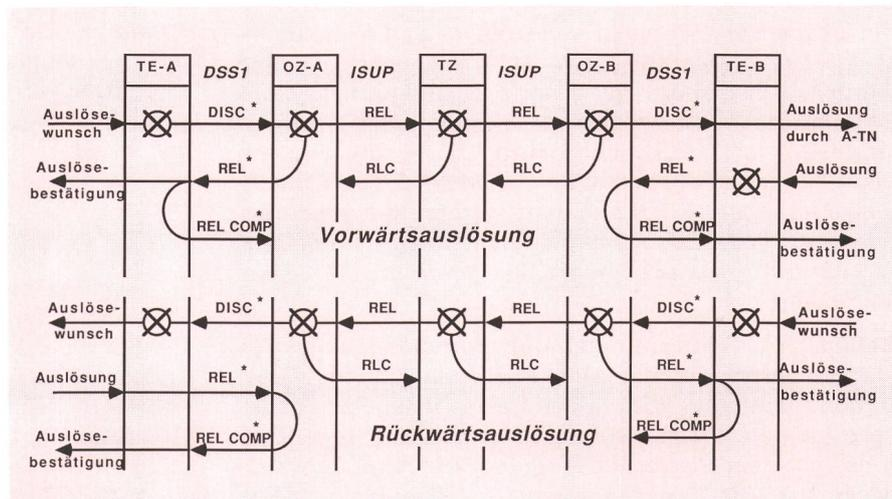
sung einer Teilstrecke der Verbindung wird mit einer Auslösebestätigung «*Release Complete Message*» (RLC) quittiert.
