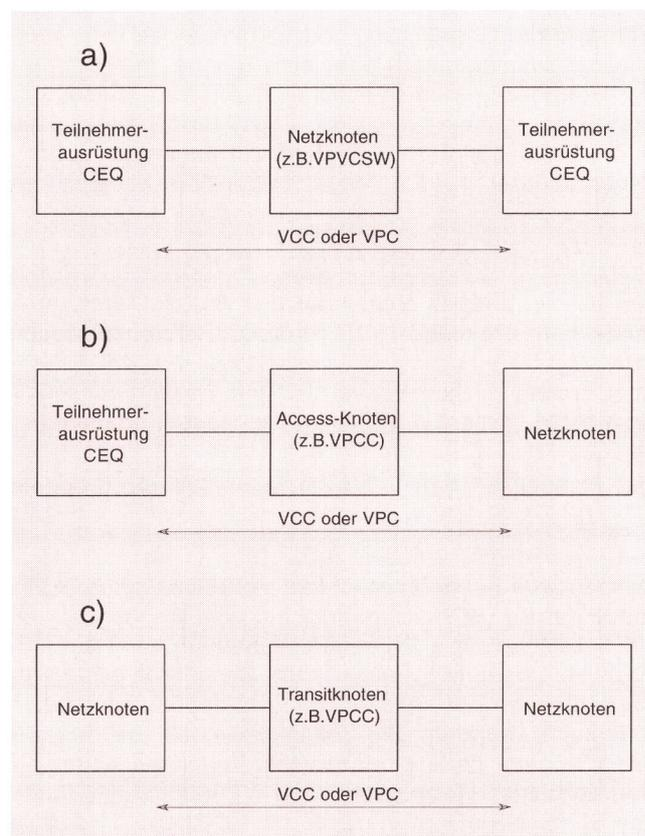
Fig. 3 Anwendungen von VP- und VC-Verbindungen
