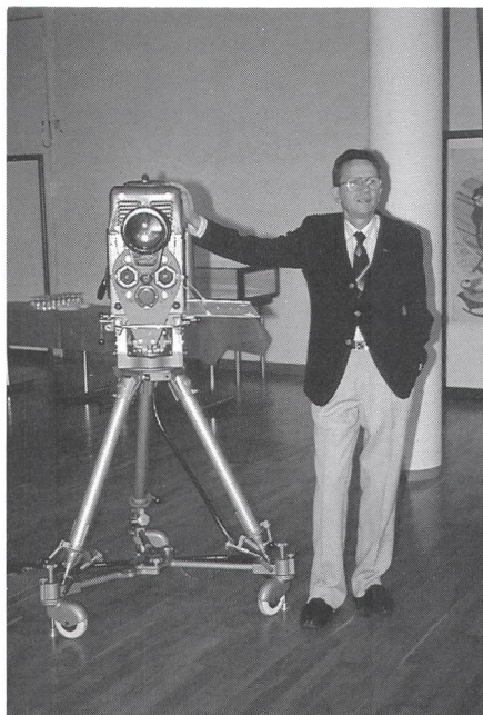
Fig. 4 Die Kameras waren mit einem Objektivrevolver ausgerüstet, da es damals noch keine Zoom-Objektive gab.
