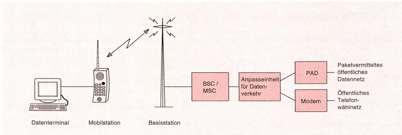
Fig. 10 Anpassung der Datenübertragung an die Standards
