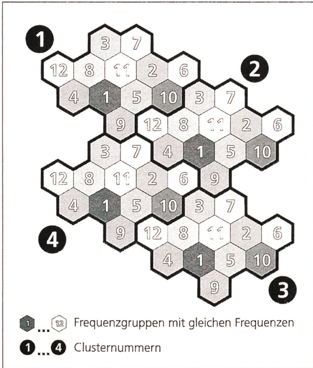
Fig. 7 GSM-Zellennetz – Frequenzplanung 12er Cluster
