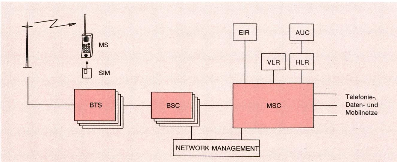
Fig. 8 GSM-Netzelemente
