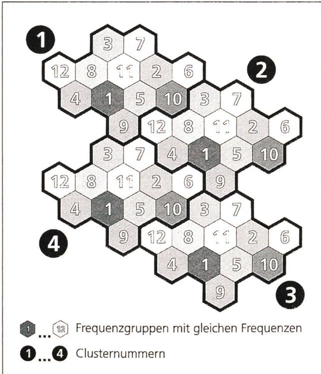
Fig. 7 GSM-Zellennetz – Frequenzplanung 12er Cluster
