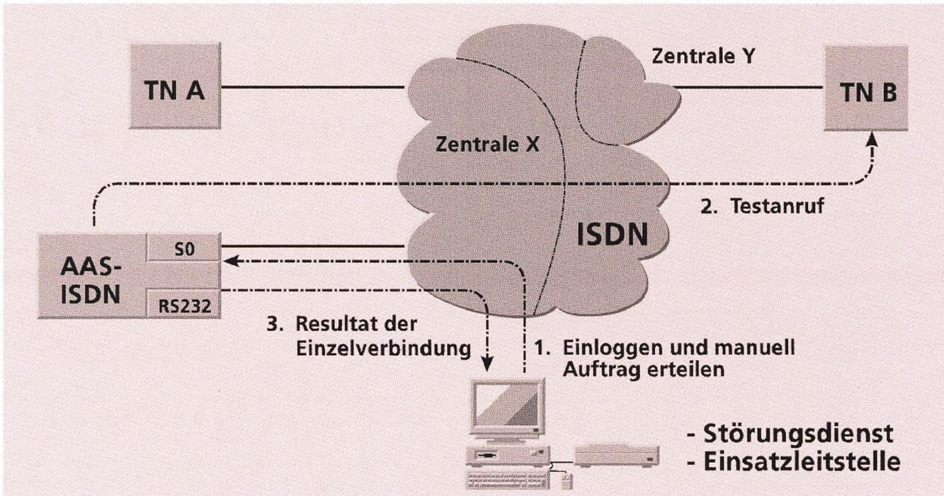
Fig. 8 Einzelverbindungsanfrage
