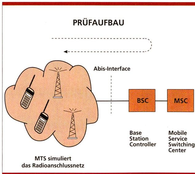
Bild 2. Prüfaufbau mit dem Mobile Traffic Simulator (MTS).
