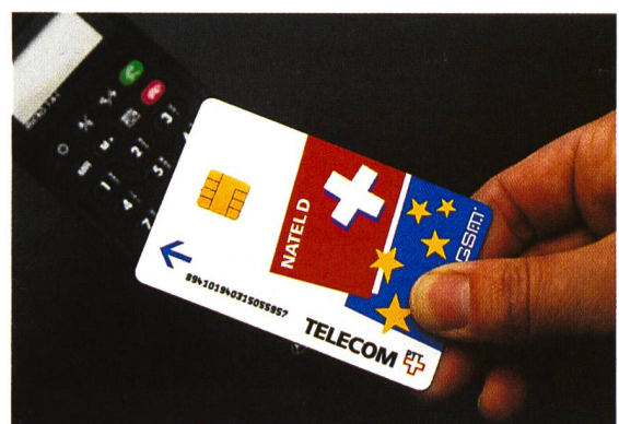
Fig. 7. La scheda SIM, la chiave personale di accesso alla rete GSM in formato carta di credito.
