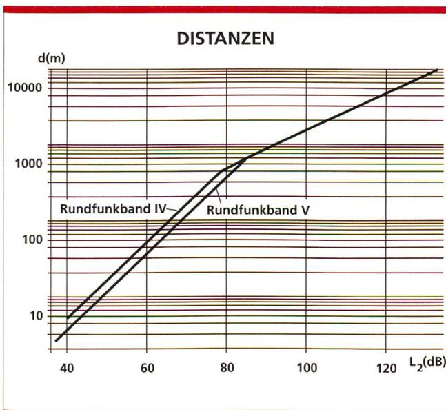
Bild 10. Minimal einzuhaltende Distanzen  $d$  zwischen den Inhouse-Funkdienstsendern und den TV-Empfangsantennenstandorten zum Schutz des Fernsehbildes im Rundfunkband IV und V in Abhängigkeit der notwendigen Ausbreitungsdämpfung  $L_2$ .
