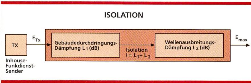
Bild 8. Modell zur Bestimmung der erforderlichen Isolation I.
