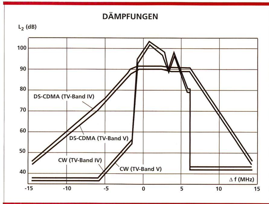
Bild 9. Ausbreitungsdämpfungen  $L_2$  [dB] für ein 100- $\mu$ W-ERP-Inhouse-Funksystem.
