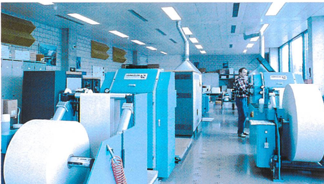
Bild 7. Laserdrucker verarbeiten Papierrollen von 12 000 m Länge oder gefaltetes Endlospapier mit einer Geschwindigkeit von 74 cm Papierschub in der Sekunde.
