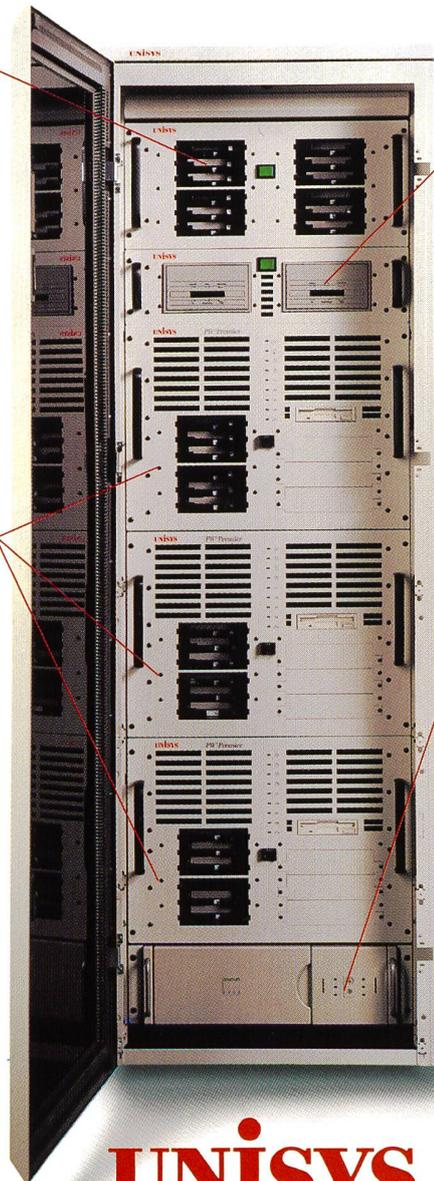
Das DAT-Stacker-Schubfach weist eine Kapazität bis 192 GB auf. Das befreit Sie ein für allemal von allen Back-up-Sorgen. Der vollautomatische Back-up wird durch zwei separate Autoloader gemanagt, die je mit bis zu zwölf Tapes bestückt sind, ohne menschliches Zutun, wohlverstanden.
