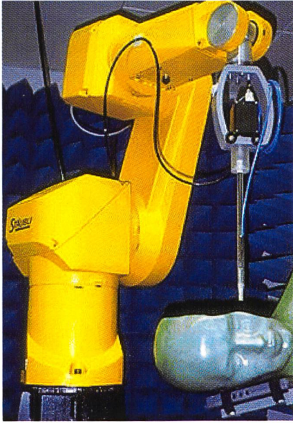
Fig. 1. Robot de mesure avec sonde triaxiale (en haut). Mannequin rempli d'un liquide comparable aux tissus humains et radiotéléphone appliqué à la tête (en bas).
