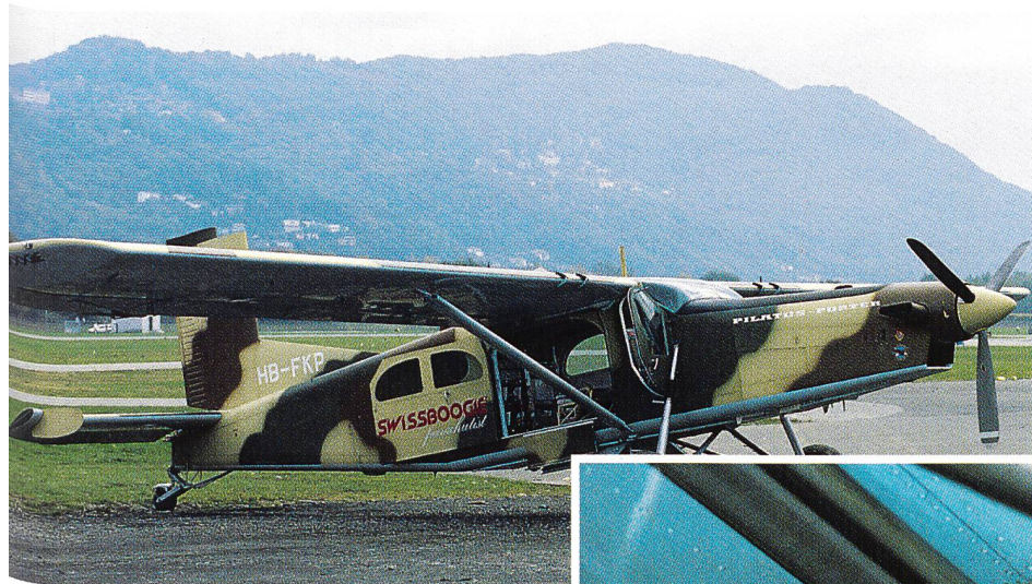
Bild 7. Das Flächenflugzeug dient als mobile Relaisstation, empfängt die Bild- und Tonsignale der Kameramotorräder und des Kamerahelikopters und gibt sie weiter an die terrestrische Empfangsstelle. Aus dem geöffneten Flugzeugboden sind die Sende- und Empfangsantenne sowie die Funkantennen sichtbar.
