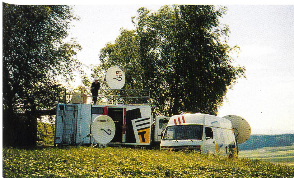
Bild 8. Terrestrische Empfangsstelle: Die beiden Empfangsantennen (links, beim Übertragungswagen) werden aufgrund der übermittelten Flugzeugposition manuell nachgeführt. Die mobile Satellitenbodenstation (rechts im Bild) leitet die Signale via Satelliten weiter in die Regie.
